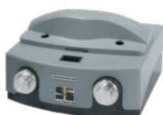
Le colorimètre AF650 est un instrument à trois champs de caractérisation visuelle de la couleur d'échantillon d'huiles ASTM. Il fonctionne par comparaison directe avec des standards de verre coloré. Il intègre les 16 standards de verre constituant l'échelle sous forme d'une paire de disques. Cet appareil est livré avec 3 tubes à essai et un certificat de calibration pour les filtres.
