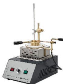
Le NCL 120 permet la détermination du point d'éclair et de feu. L'instrument est équipé d'un élément chauffant, réglable en puissance par le régulateur d'énergie sur le panneau avant. La veilleuse et la flamme sont réglables par vanne.
