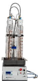
Le NDW Tech permet de nettoyer et sécher automatiquement vos diffuseurs en pierre ou acier inoxydable. Il permet de réduire l'exposition des utilisateurs aux solvants.
