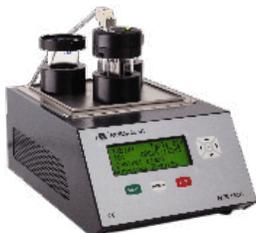
Entièrement automatique, le NSB TECH offre un test précis de la teneur en sel dans le pétrole brut. Ce test mesure la conductivité dans le pétrole brut en raison de la présence de chlorures dans les sels de sodium, calcium et magnésium par des méthodes électroniques.
