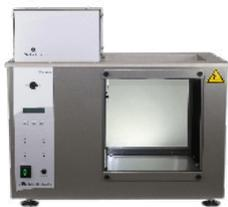
Ce bain de viscosité, NVB Classic, a une plage de température allant de l'ambient à +230°C (stabilité de  $\pm 0.01^\circ\text{C}$ ). Ce bain de 40 litres a une ouverture de 260x240mm et possède 7 ouvertures pour suspendre les viscosimètres. Un serpentin de refroidissement est intégré afin de pouvoir travailler en dessous de la température ambiante.
