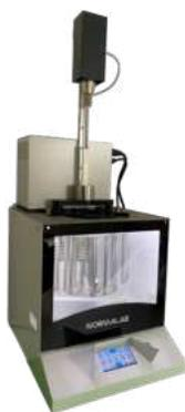
La DEM Tech est un appareil de test semi automatique qui permet d'analyser la séparation entre l'eau et différents types d'huiles. Il contient 4 stations de mesure (+2 stations de préchauffage). Sa pôle d'agitation se positionne automatiquement dans l'éprouvette (6mm entre la pôle et le fond de l'éprouvette). Grâce à sa fenêtre large et à son éclairage LED, le test est facilement observable. Le paramétrage est simple grâce à l'écran tactile intégré.
