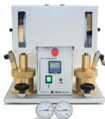
Le malaxeur de graisse, GWM Classic, automatise la procédure manuelle de malaxage nécessaire pour la réalisation du test de stabilité au cisaillement. L'appareil réalise 60(±10) coups/min avec des déplacements de 67mm. Il est utilisé pour vieillir les graisses avant l'essai de pénétrabilité.
