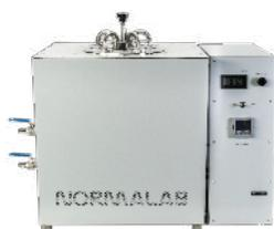
Le dispositif détermine les gommes actuelles dans les carburants par évaporation à l'aide de jet d'air ou de vapeur. L'appareil dispose d'une triple régulation numérique pour : la température de l'air ( $155 \pm 0.5^{\circ}\text{C}$ ), la température de la vapeur ( $232 \pm 2^{\circ}\text{C}$ ) et les débits d'air et de vapeur ( $1000 \text{ mL/s} \pm 15\%$ ).
