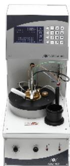
Le NAB 440, entièrement automatique, possède 3 méthodes standard prédéfinies et 1 méthode de recherche rapide. Cet appareil possède un double système de détection thermique et d'ionisation. L'interface conviviale permet de mémoriser les 200 derniers résultats. Le NAB 440 peut être raccordé à un cryo-thermostat externe et fonctionne entre -30°C et +110°C.
