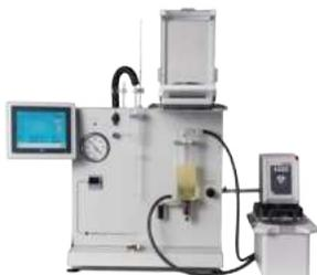
Le ARV Tech mesure de manière précise le temps nécessaire à une huile pour se séparer de l'air. Le test est réalisé à l'aide de la méthode Impinger, avec une huile chauffée à une température de 25°C, 50°C ou 75°C. L'écran permet de voir l'évolution du test en temps réel. La balance connectée permet une détermination automatique.
