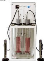
Ces appareils sont utilisés pour détecter des caractéristiques de moussage dans les huiles lubrifiantes. Ce modèle permet de réaliser les séquences I,II ou III.
