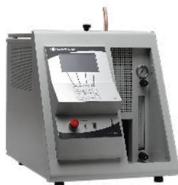
Entièrement automatique et facile à utiliser, le NMC 445 fournit toutes les exigences de sécurité pour une mesure des résidus de carbone formés après l'évaporation et la pyrolyse des produits pétroliers.
