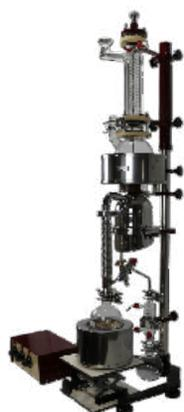
L'extracteur d'asphaltènes ASPHAN 02 permet un gain de temps de 50% par rapport à la méthode traditionnelle. Avec un test rapide et précis, il diminue le coût de l'analyse grâce à une intervention minimale de l'opérateur. L'ASPHAN 02 est conçu pour limiter les émissions de solvants.
