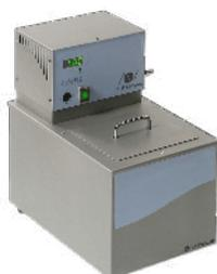
Le bain thermostatique a une gamme de température allant de l'ambient à  $+250^{\circ}\text{C}$ . Afin de travailler en dessous de la température ambiante, il est possible de le raccorder à un circuit de refroidissement externe. Le bain est équipé d'un drain. En option, vous avez la possibilité d'augmenter la capacité de 6 à 9 échantillons.
