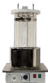
Cet appareil est conçu pour le nettoyage externe et interne de tous les types de tubes viscosimétriques. Les tubes sont mis en suspension dans des vapeurs de solvant. Une connexion à un circuit externe de refroidissement est nécessaire pour recondenser les vapeurs. L'appareil permet de réduire l'exposition des utilisateurs aux solvants.
