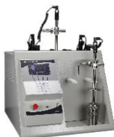
La NPI 442, version bain sec, offre un écran graphique avec un logiciel simple d'utilisation et peut enregistrer les 200 derniers résultats. La plage de températures va de l'ambient à  $+120^{\circ}\text{C}$ . Le dispositif enregistre jusqu'à 96h de test en continu. Afin de sécuriser le remplissage et la décompression des cylindres, le NCP 210 (en option) est vivement recommandé pour assurer la manipulation.
