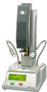
Le pénétromètre semi-automatique, NPN Tech, est un appareil compact capable de mesurer automatiquement la valeur de la pénétration de l'échantillon. Cet appareil est utilisé pour mesurer la consistance et la résistance de différents types de graisse (pâteux, crémeux, semi-solides ou très visqueux). Une détection automatique de la surface est disponible pour les échantillons conducteurs.
