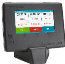
Le CHRONOTECH est un chronomètre basé sur un logiciel. Il permet le calcul automatique de la viscosité en entrant la constante du tube dans sa mémoire interne. Mobile et facile à manipuler, le chronotech permet d'effectuer trois mesures de temps différentes simultanément.
