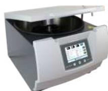
La centrifugeuse NCP Tech a été conçue pour déterminer la teneur en eau et en sédiments dans les huiles usagées et le pétrole mais aussi pour les caractéristiques de désémulsibilité et de précipitation. L'appareil permet une utilisation rapide et simple pour des mesures précises. La NCP Tech 2 dispose d'une version non-chauffée et d'une version grand format pouvant contenir jusqu'à 8 tubes.
