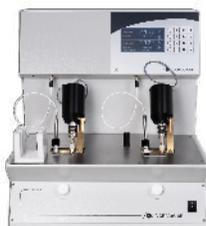
Le NAE 440 est le seul appareil de test du point d'aniline sur le marché à disposer de 2 postes autonomes et indépendants. L'appareil permet un contrôle visuel du résultat pendant le test. Le NAE fonctionne sur une plage de température allant de -10°C à +150°C. Par mesure de sécurité, l'élément chauffant est protégé en cas de rupture d'un tube. Un cryostat est nécessaire pour les températures allant en dessous de la température ambiante.
