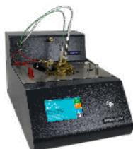
Le NPM Tech est un appareil compact semi-automatique qui fournit des résultats rapides et fiables. Son utilisation est simple et sécurisée, et permet de réduire l'intervention de l'opérateur. L'appareil se régule seul grâce à la montée en température prédéfinie et à sa turbine qui permet un refroidissement rapide de l'échantillon après le test.
