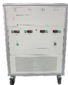
Le cabinet de test, CPP Classic, est réfrigéré mécaniquement par du gaz sans CFC. Il dispose de 4 compartiments (0, -18, -33, -51°C) contenant chacun 4 puits dont la température est contrôlée via un affichage digital. Pour la température limite de filtrabilité (ASTM D 6371 - IP 309 - EN 116), un kit est disponible en option.
