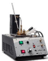
Le NPM 131 dispose d'un élément chauffant, d'un système d'agitation automatique et un contrôle simple de la flamme. L'appareil utilise les méthodes A et B.
