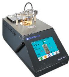
Le NBA 450 détermine automatiquement le point de ramollissement grâce à une cellule optique. Il incorpore un élément chauffant protégé et résistant à tout débordement de liquide. Avec les 4 méthodes prédéfinies, il offre la possibilité de tester bitume, cire, résine...
