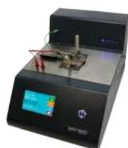
Cet appareil est équipé d'une rampe de chauffe automatique. Pour effectuer un point d'éclair avec le NPV Tech, il est possible de travailler avec de petits volumes (2 ou 4 mL). La prise de mesure est possible grâce à la détection automatique par thermocouple. L'appareil offre la possibilité d'exécuter la méthode manuellement ou de définir une vitesse de chauffe automatique.
