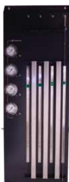
Cet appareil permet de caractériser la qualité des fractions pétrolières en tant que composants de mélange d'essence et en tant qu'aliments pour les processus de reformage catalytique. Ces informations sont importantes pour caractériser les produits pétroliers issus du reformage catalytique et du craquage thermique en tant que composants de mélange pour les carburants pour moteurs et aviation.
