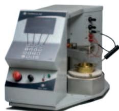
Le point d'éclair, NCL 440, associe le flash et la détection du point de feu. Entièrement automatique, cet appareil offre une bonne répétabilité et productivité de vos analyses. Simple d'utilisation, il suffit de sélectionner le programme pré-installé : l'évolution du test s'affiche en temps réel sur l'écran
