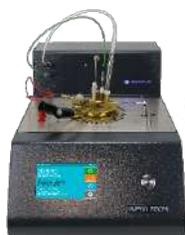
Le NPM Tech est un appareil compact semi-automatique qui fournit des résultats rapides et fiables. Son utilisation est simple et sécurisée, et permet de réduire l'intervention de l'opérateur. L'appareil se régule seul grâce à la montée en température prédéfinie et à sa turbine qui permet un refroidissement rapide de l'échantillon après le test.
