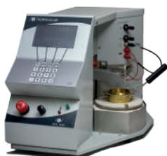
Le point d'éclair, NCL 440, associe le flash et la détection du point de feu. Entièrement automatique, cet appareil offre une bonne répétabilité et productivité de vos analyses. Simple d'utilisation, il suffit de sélectionner le programme pré-installé : l'évolution du test s'affiche en temps réel sur l'écran.
