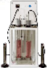
Le FOAM HT peut effectuer un test jusqu'à maximum 150°C. Pour les séquences I,II, III et IV dans un seul bain.
