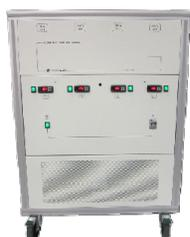
Le cabinet de test, CPP Classic, est réfrigéré mécaniquement par du gaz sans CFC. Il dispose de 4 compartiments (0, -18, -33, -51°C) contenant chacun 4 puits dont la température est contrôlée via un affichage digital. Pour la température limite de filtrabilité (ASTM D 6371 - IP 309 - EN 116), un kit est disponible en option.
