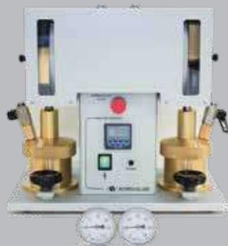
Pour la préparation de l'échantillon, la graisse a besoin d'être travaillée. Le GWM Classic prépare la graisse avant qu'elle ne soit utilisée pour le test de cisaillement. Ce malaxeur se compose d'une double unité compacte et possède un compteur électronique qui permet de calculer le nombre de coups (jusqu'à 100 000).
